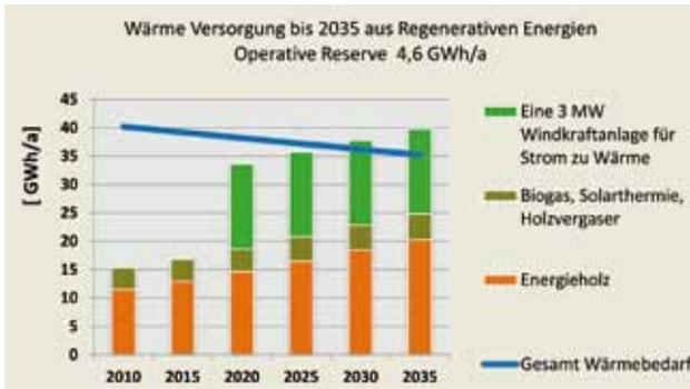
Abb. 3 – Strom zu Wärme: Eine Windkraftanlage von ca. 3 MW Nennleistung deckt bis 2030 42 % der Wärmeversorgung mittels Wärmepumpen Anlagen (Gebäude Sanierungsrate 1,2 % pro Jahr).
