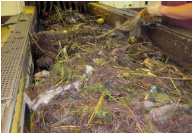
Vermeidbarer und teurer Aufwand: Plastiktaschen müssen in Handarbeit aus dem Laufband gezogen werden.
